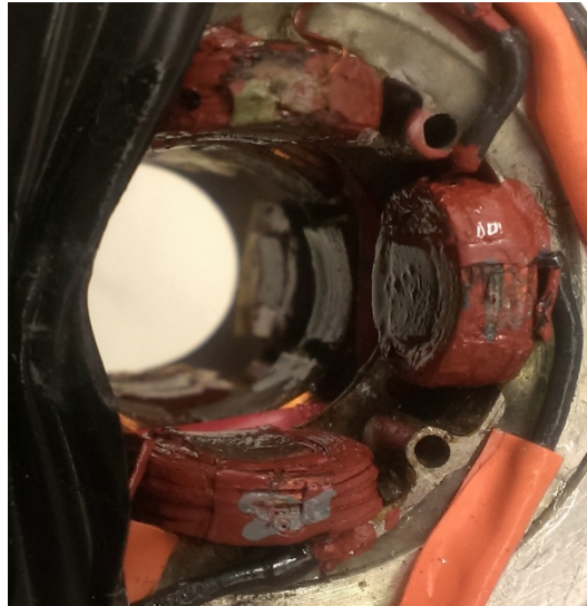
Figure 15 : Rear AMB on the shearing device
