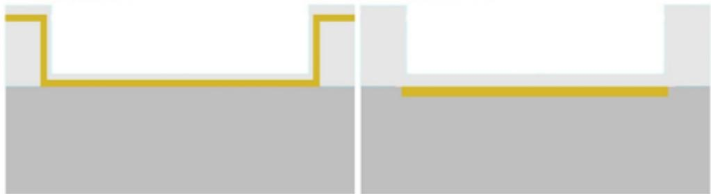
Figure 5.5 (c) PECVD Capping Oxide (d) Rapid Thermal Annealing
